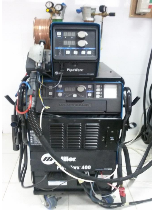
Figure 02: photo du poste de soudage Miller PipeWorx 400 (380/400Volt).
