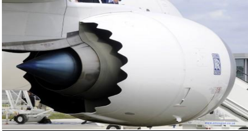
Figure I.17 : Tuyère à chevrons
