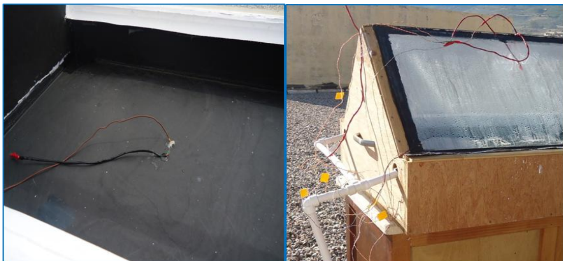
Figure III.13 : Photo montrant l'emplacement des thermocouples.
