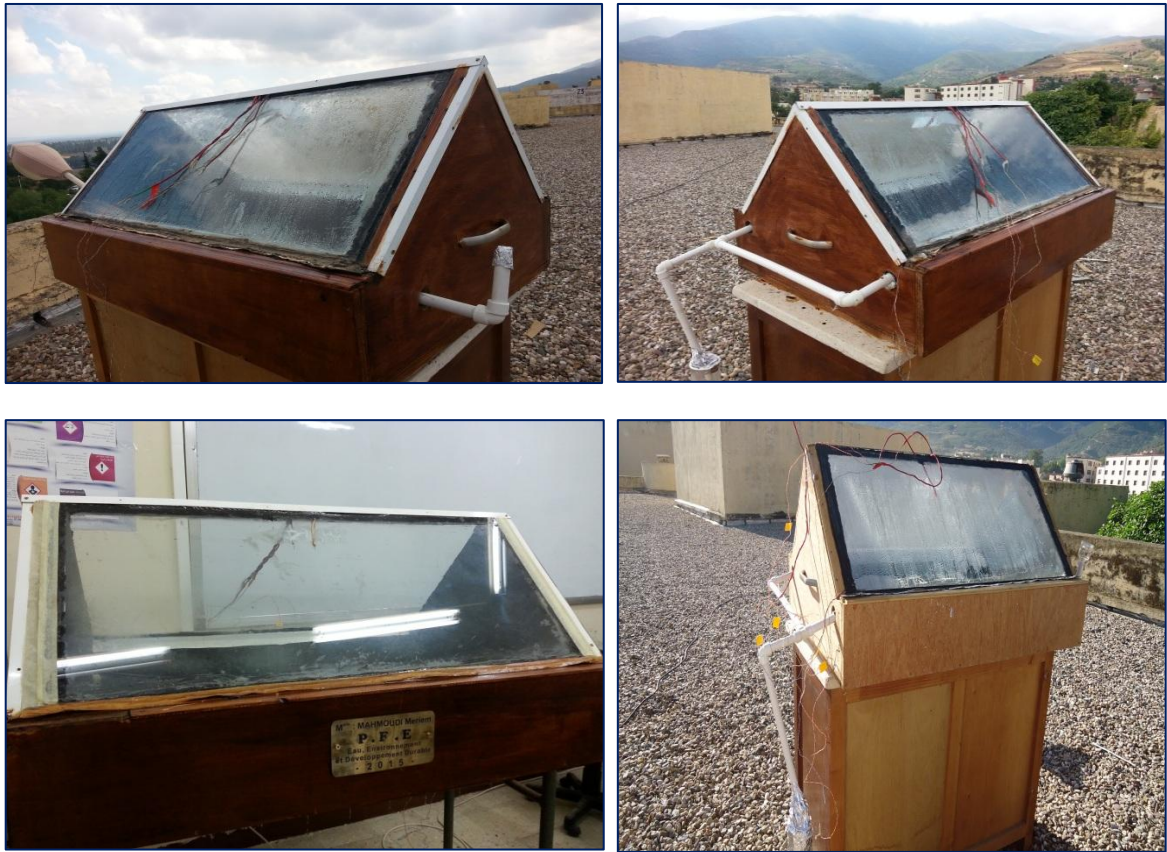
Figure III.9 : Photos du distillateur solaire réalisé.
