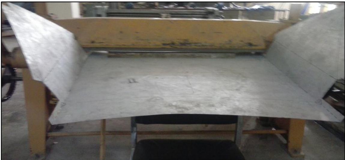
Figure III.1 : Photo de pliage des parois de bac.
