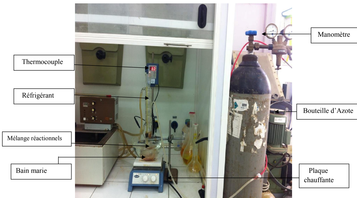
Figure 2.5 : Schéma d'installation de la réaction d'oxydation du limonène
