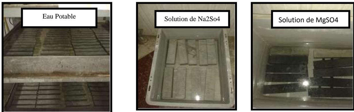
Figure III.5. Eprouvettes prismatiques conservées dans l'eau et les solutions sulfatées
