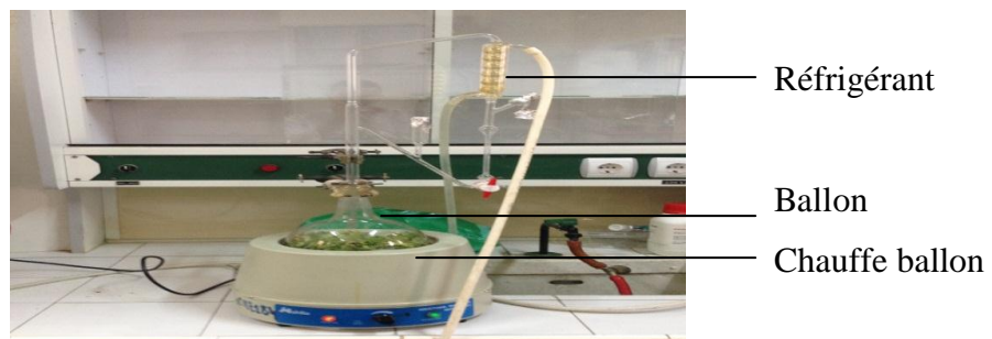
Figure III.2: Hydrodistillation de géranium rosat : Montage d'hydrodistillation (Dispositif Clevenger).
