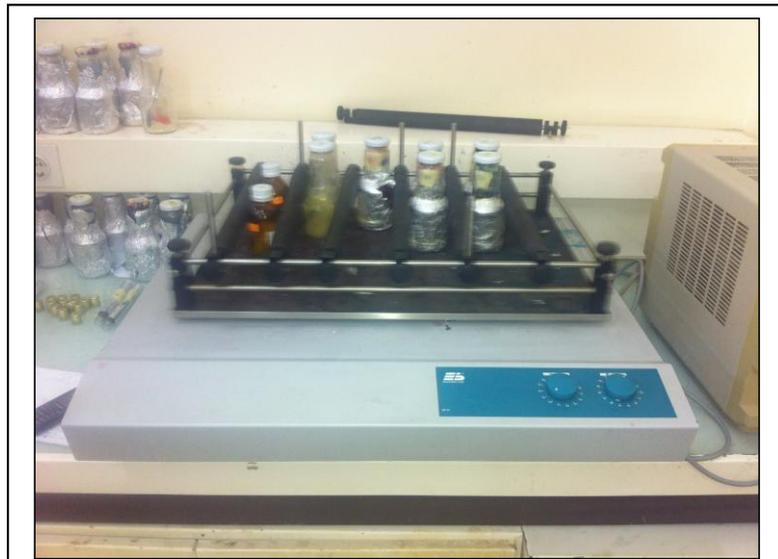
**Figure III.8:** Secoueur de type EDMUND BÜHLER GMBH SM-30.
