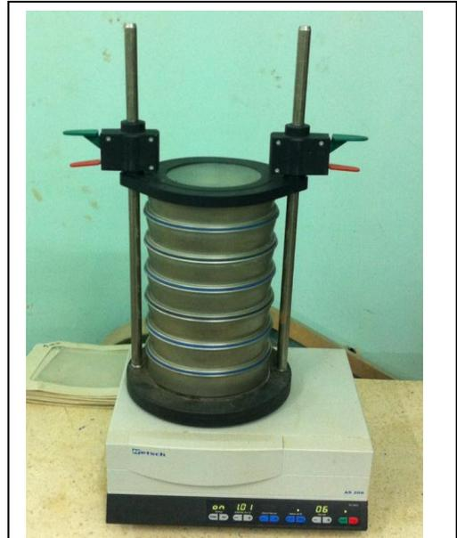
**Figure III.1:** Tamiseur électrique.
