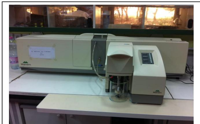
**Figure III.2:** Granulométrie laser humide.
