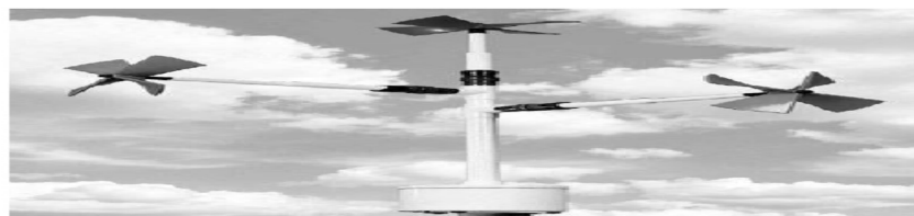
Figure 2. 5 Anémomètre tridimensionnel à hélice
