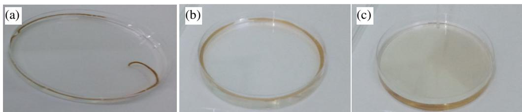
**Figure 3.2:** Déplacement de pétrole suite à l'application du biosurfactant brut (a) HF644, (b)HMU644 et (c) témoin eau distillée.
