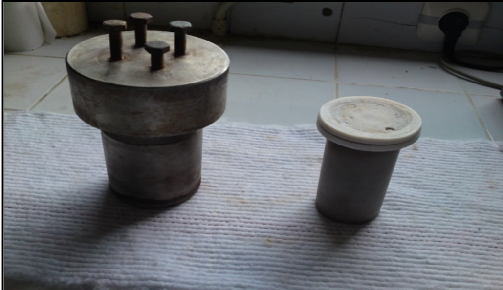
Figures -15- Autoclave utilisé pour la synthèse de zéolithe et sa chemise en téflon.
