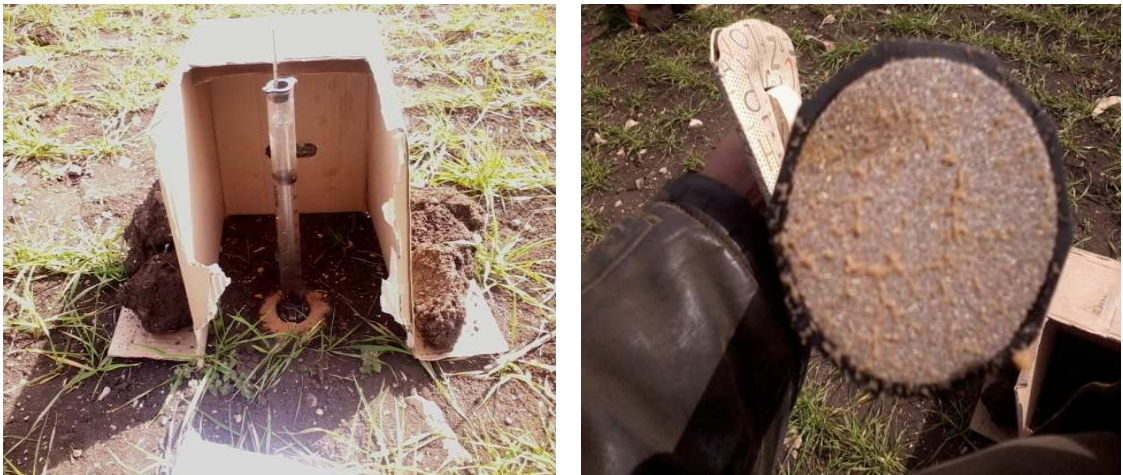
Figure 4.2 : Mini-infiltromètre à disque à droite et Disque en acier inoxydable à gauche.
