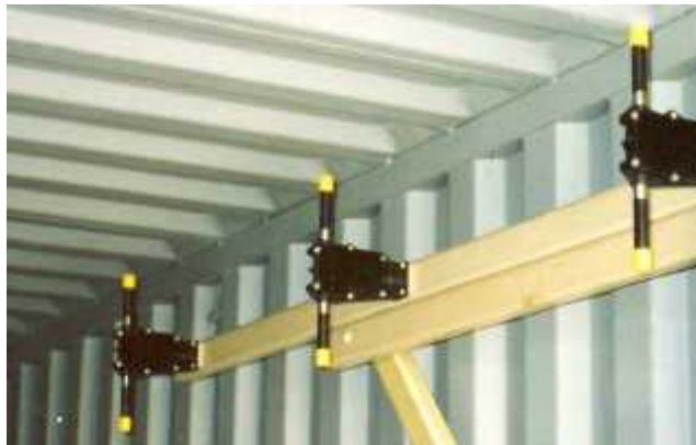
Figure.3.4 – Réseau linéaire de 3 dipôles
