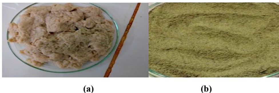
**Figure n° 25** : le mucilage 01 avant (a) et après le séchage, broyage (b)
