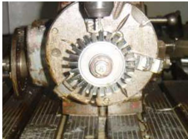
**Figure (3-25) : l'opération de l'usinage des aubes est finie.**
