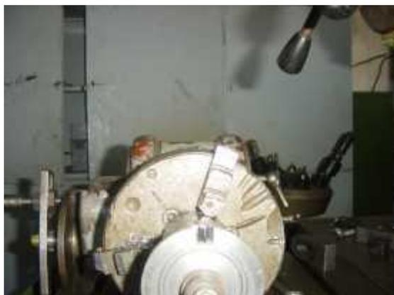
**Figure (3-21) : l'usinage de la première aube est fini.**
