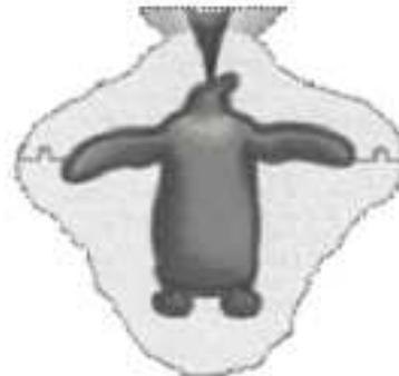
Le moule principal couvre l'argile. Le caoutchouc liquide versé autour de l'argile durcit. Le plâtre garde le caoutchouc en place
