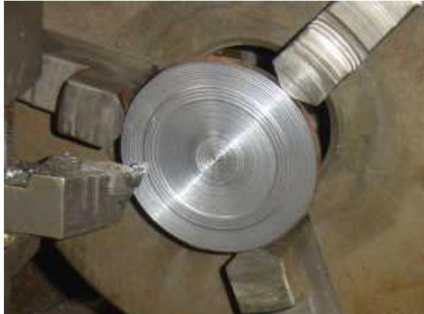
**Figure (3-8) : la finition de dressage et de chariotage.****5-1-3-/ Le Perçage :**
