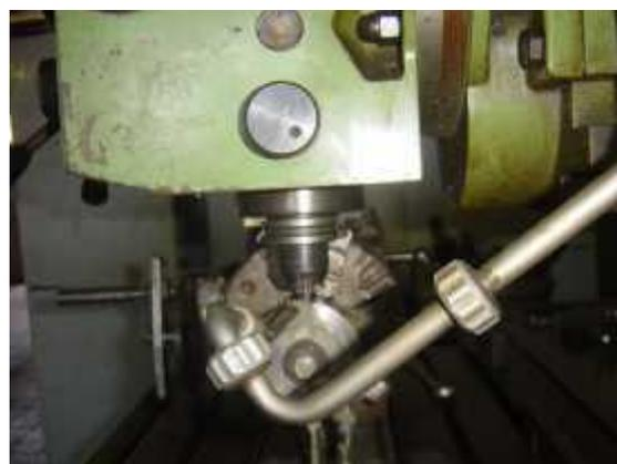
Figure (3-20) : commencement d'usinage de la première aube.
