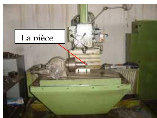
**Figure (3-11) : le dispositif de fixation****Figure (3-12) : le centrage de la pièce.**
