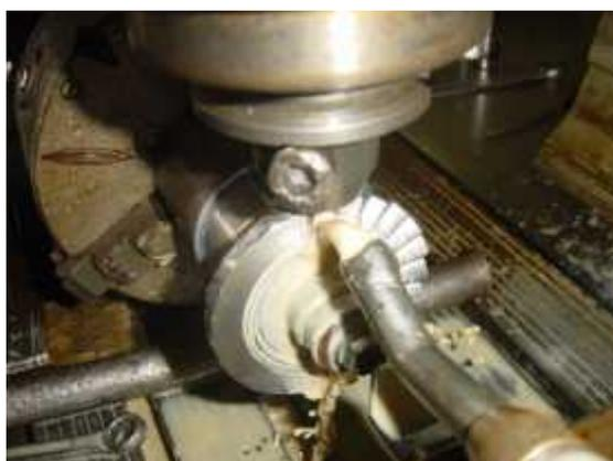
**Figure (3-22) : l'usinage de la huitième aube.**
