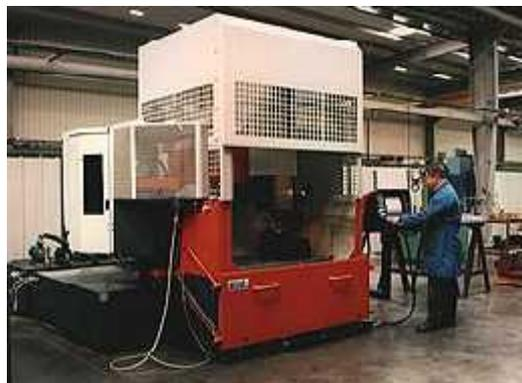
**Figure (2.7) : machine d'électroérosion.**
