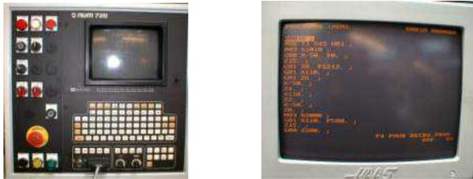
**Figure (2.2) : Commande numérique de la fraiseuse.**
