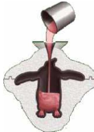
de la cire chaude est versée dans le moule, capturant les détails que le caoutchouc a déposé dans l'argile
