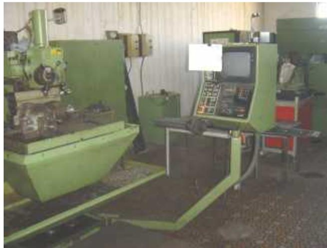
**Figure (3-10) : la fraiseuse à commande numérique « HEIDEN HAIN ».**
