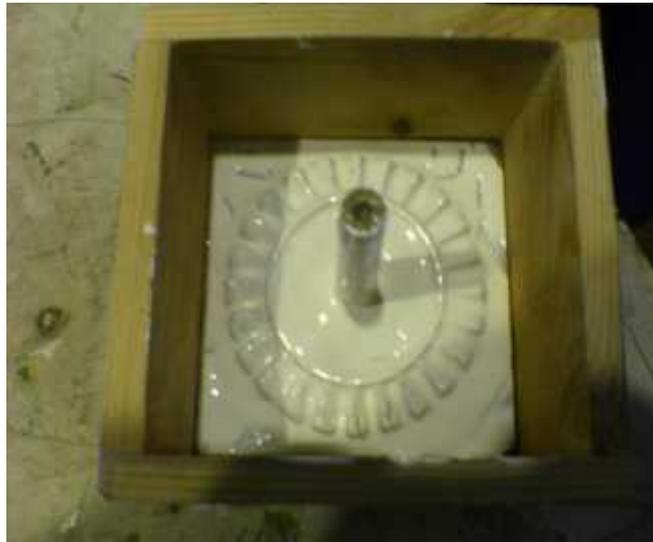
**Figure (4-9) : la mise de la couche de contact.**
