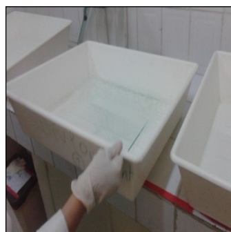
La plaque dans les solutions de développements 1 et 2
