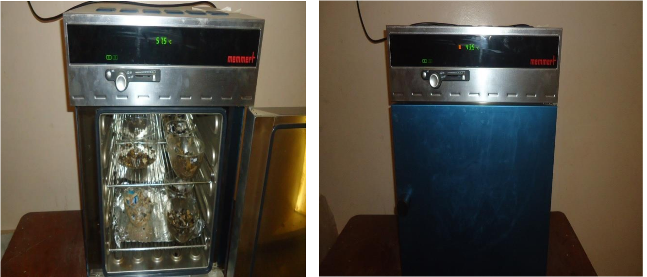
Figure III.7 : Etuve ayant servie pour le séchage des déchets
