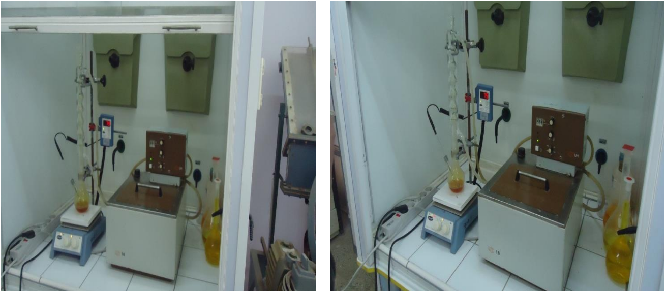
Figure III.10 : dispositif de minéralisation d'échantillon (déchet broyé)
