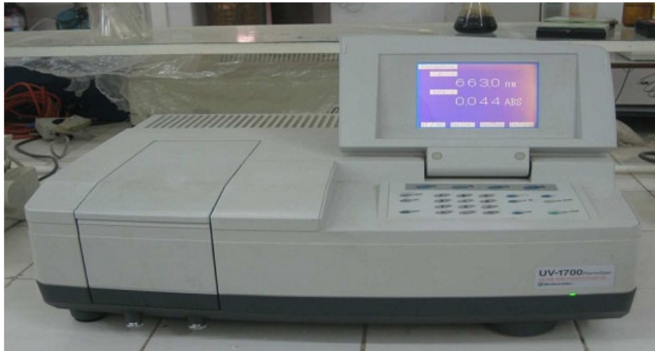
Figure I.1: Schéma représentatif d'un spectrophotomètre UV-Visible de type SHIMADZU-1700.
