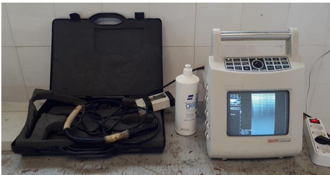
**Figure 48:** Echographe ESAOTE PieMedical avec une sonde linéaire munie d'un tube de guidage. Et un flacon de gel d'échographie.
