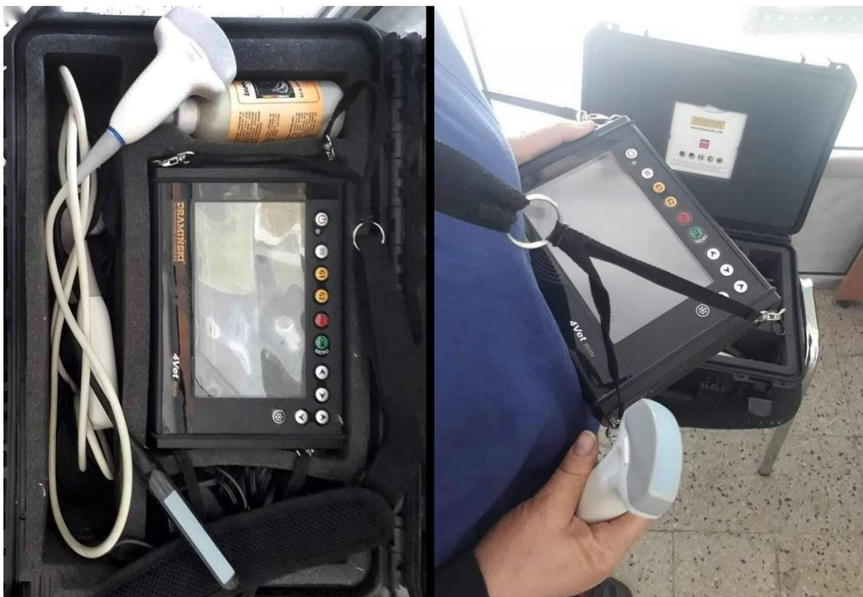
**Figure 47 :** Echographe Draminski 4Vet mini pourvu d'une sonde convexe de 5 MHz et 8 MHz.
