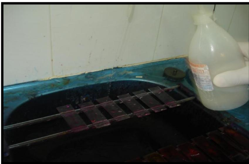
**Figure 7.9 : Lames recouvertes d'alcool.**
