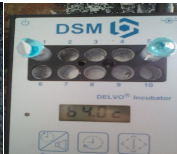
FIGURE 21 : à 64 °c mettre le tube dans DELVO Test pendant 3 h
