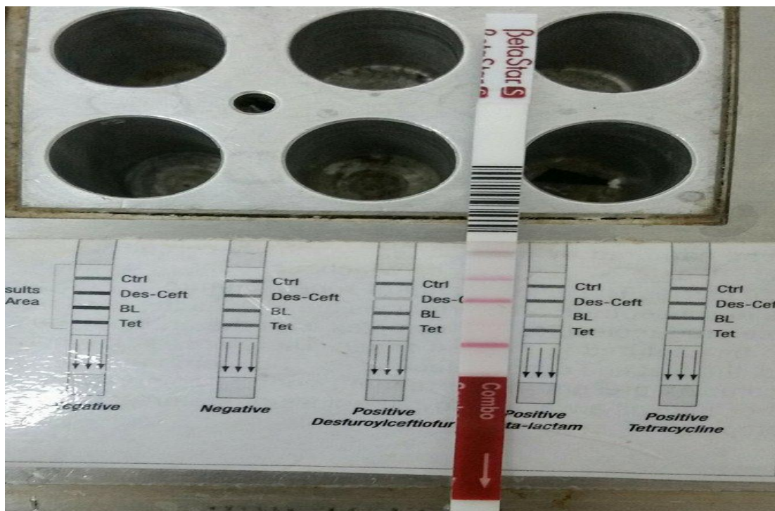
FIGURE10 : la lecture lorsque le test est négatif la barre correspondant aux Béta lactame est gommé (éliminé) donc présence d'antibiotique Béta lactame dans l'échantillon de lait
