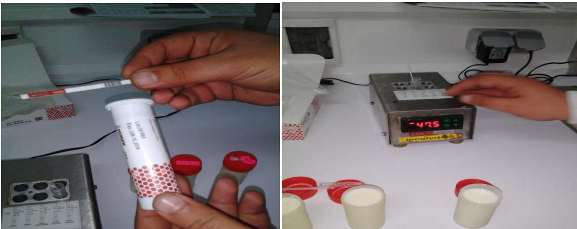
FIGURE7 : l'incubation de tube après avoir mettre la bandelette
