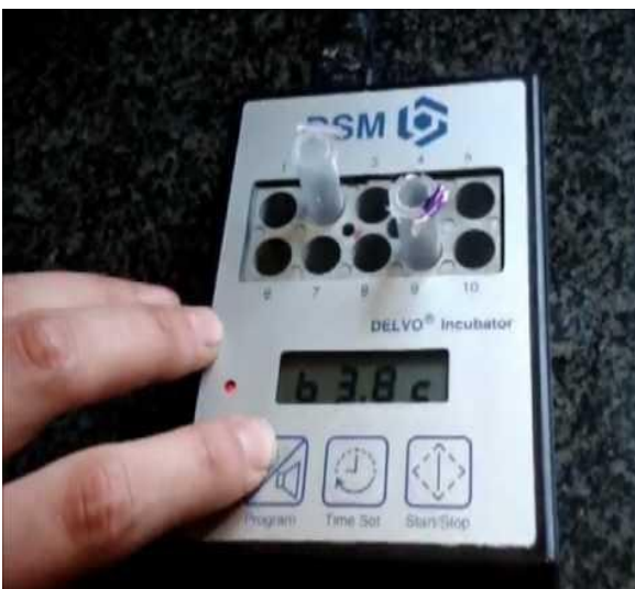
FIGURE 21 : à 64 °c mettre le tube dans DELVO Test pendant 3 h
