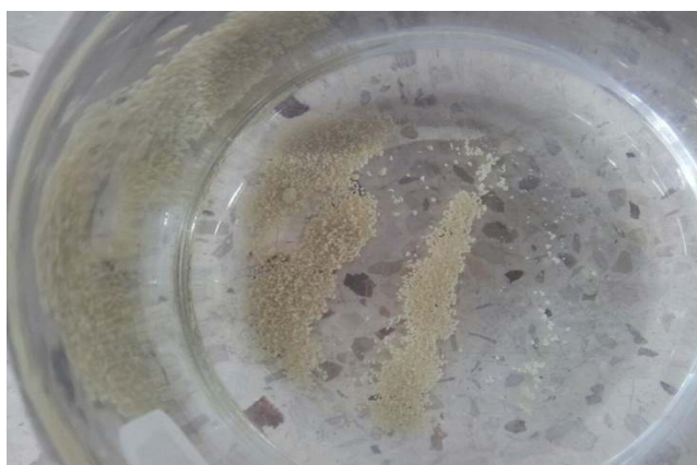
Figure III.3 : structure des floccs à pH 6
