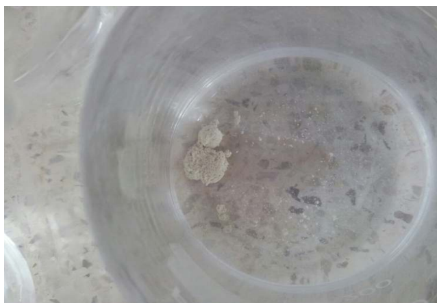
Figure III.2 : structure des floccs à pH 9
