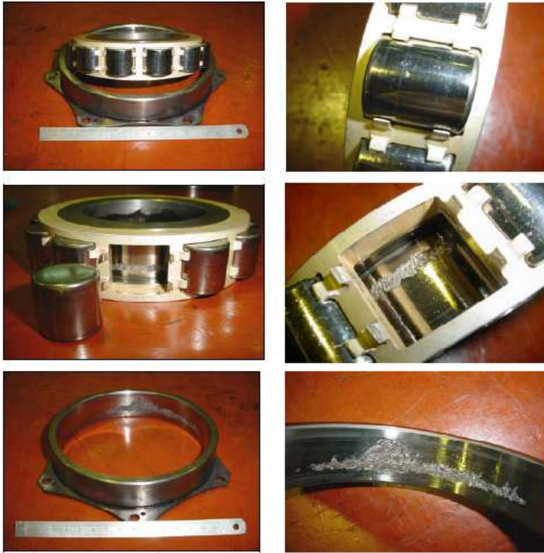
Fig. (IV-24) : roulement à rouleaux N° 15 P/N 3111931-01 S/N RH12694 TSN 7 765
