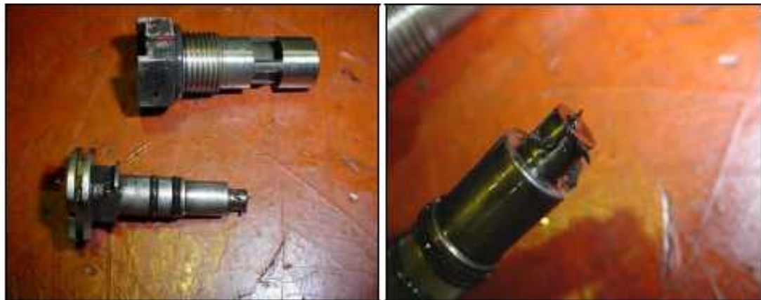
Fig. (IV-21) : détecteur de limailles RGB
