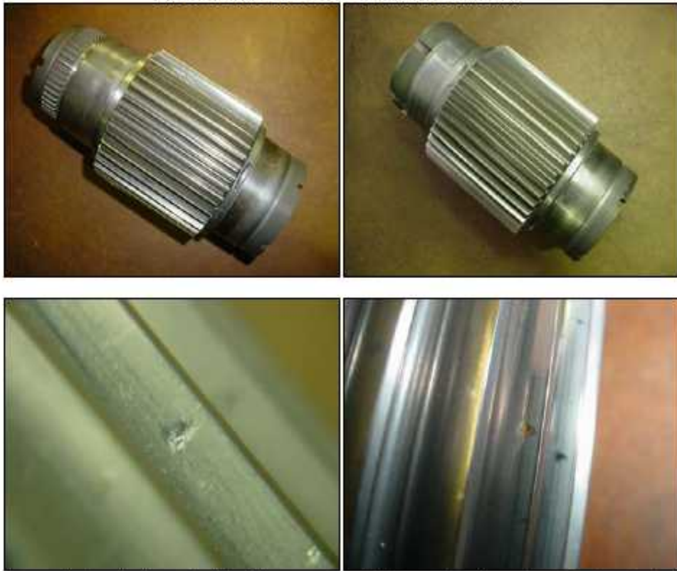
Fig. (IV-25) : pignons d'entraînement gauche et droit
