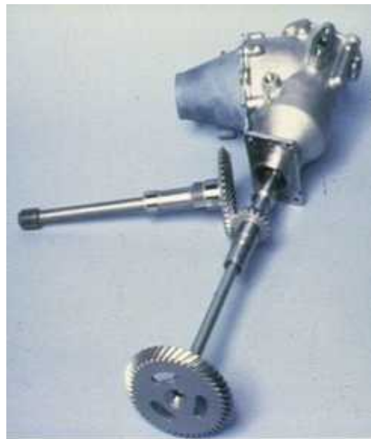
Fig. (II-10) : Angle d'entraînement de l'AGB
