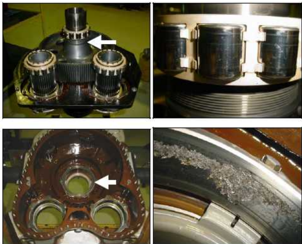
Fig. (IV-23) : vu d'ensemble localisant l'emplacement du roulement a galet N° 15
