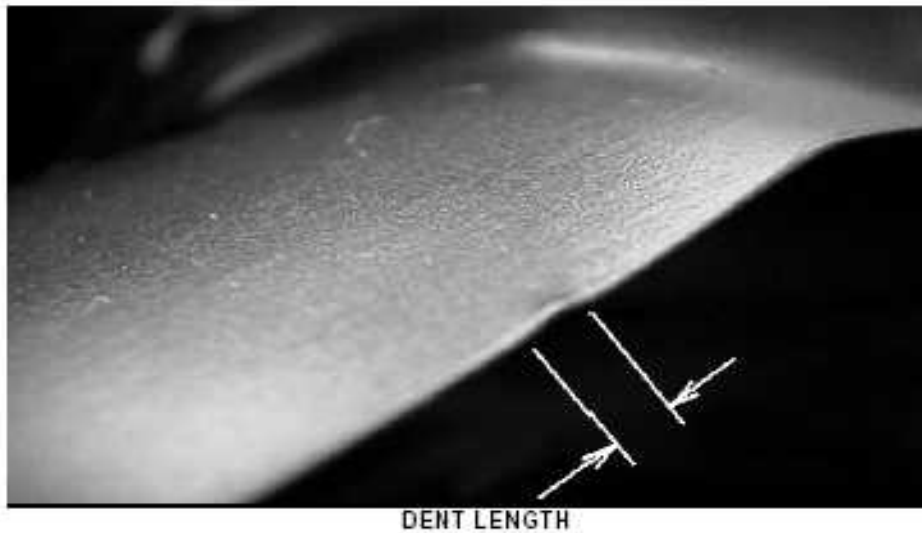
Fig. (IV-2) : exemple d'une bosselure (Dent) au compresseur HP
