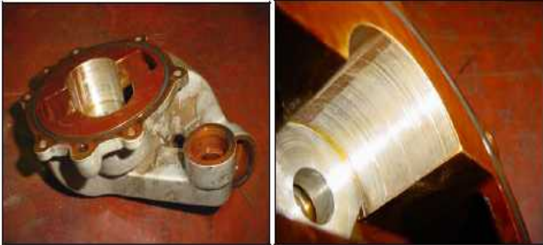
Fig. (IV-22) : pompe de récupération RGB
