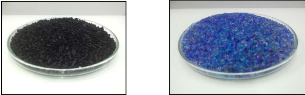
**Figure 3.2 : Adsorbants simples (charbon actif et gel de silice)**
