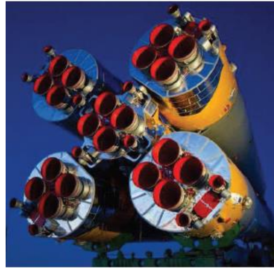
b) Tuyère TVC principal et auxiliaire du Soyouz TMA
