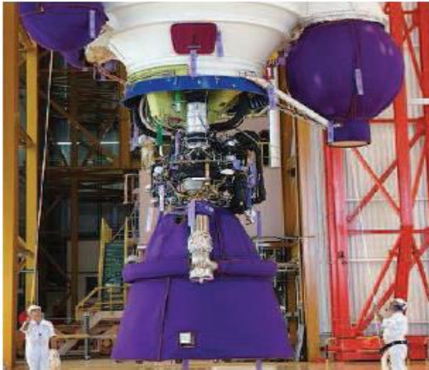
a) Moteur Ariane 5 Vulcane 2 monté sur le cardan de châssis de support et Actionneurs hydrauliques
