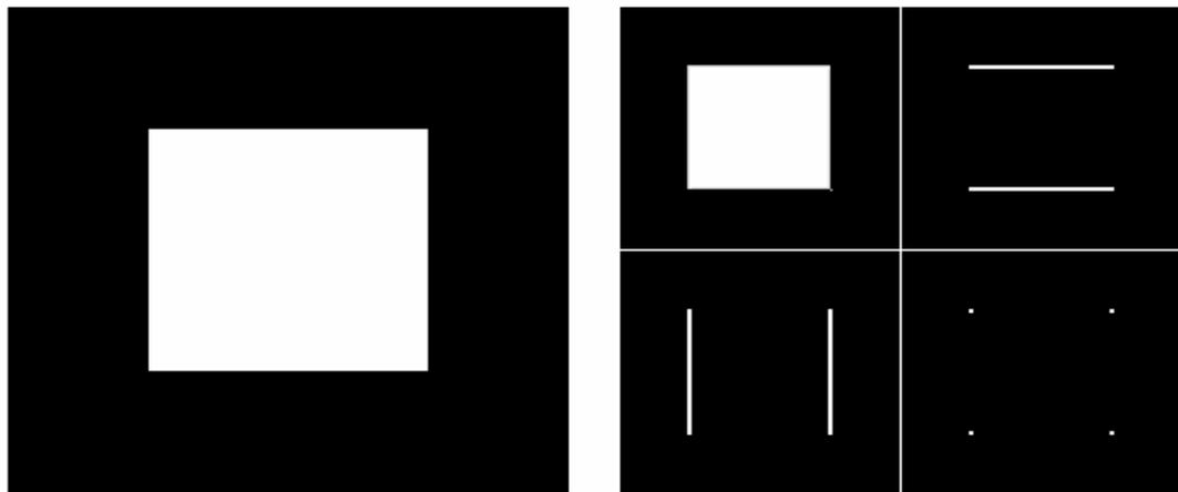
Figure 3.17 : Une image (à gauche) et ses coefficients d'ondelettes (Matrices de droite).
