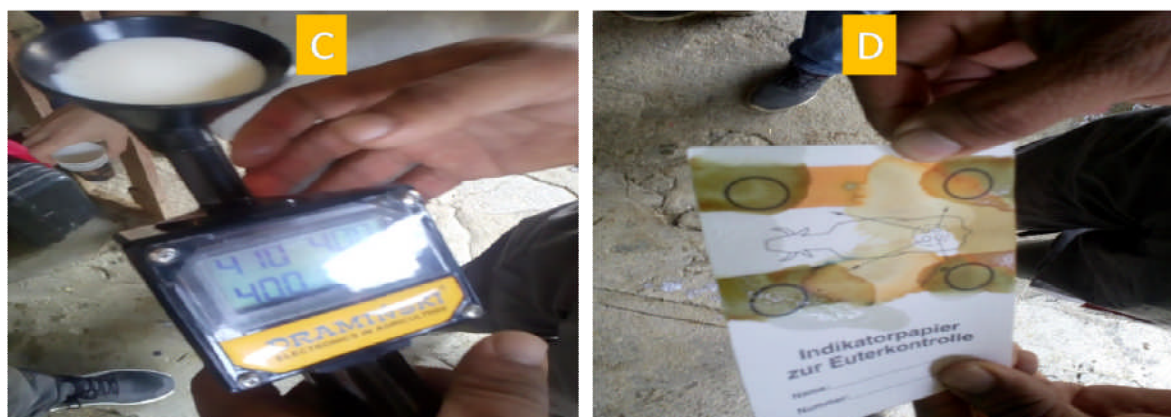
Figure n°15 : Lecture de la conductivité électrique du lait (C). Papier pH (D).
