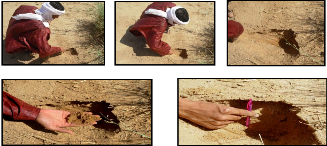
Figure 1.19 : Détermination de l'humidité au sol (original 2009).
