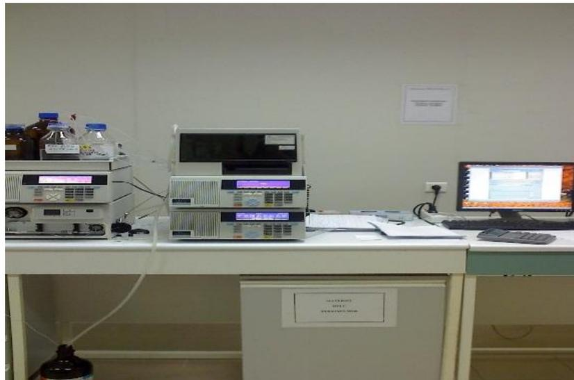
**Figure III-3:** les appareils de Chromatographie en phase liquide à haute performance
