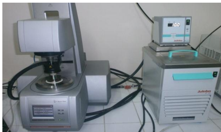
Figure III.1: Rhéomètre Anton Paar Modulat Compact Rheometer MCR 302.
