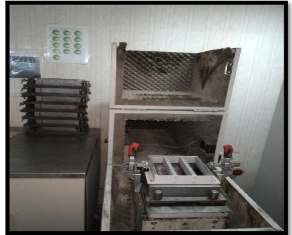
**Figure III.4: le moule des éprouvettes et table à choc de moulage**
