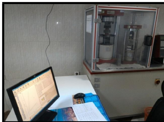
**Figure III.6 Essais mécaniques de flexion et de compression**
