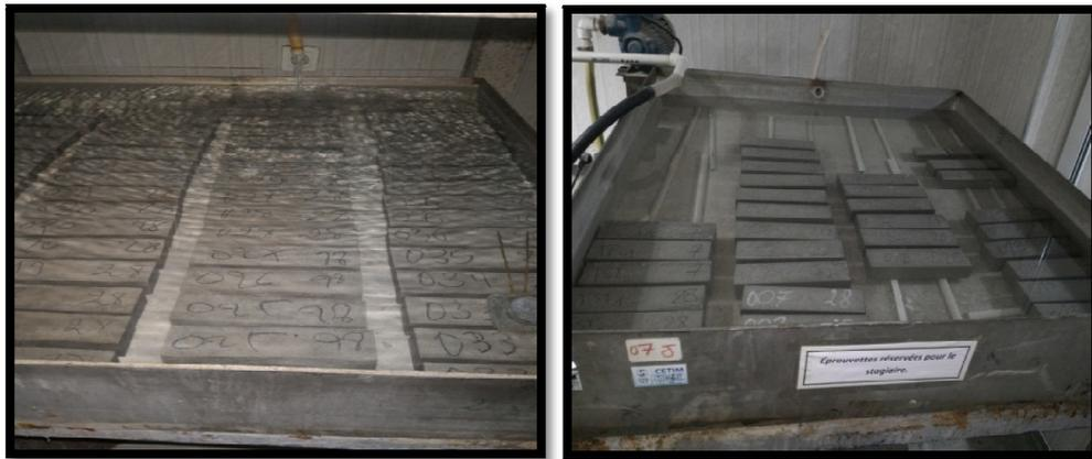
**Figure III.5. Bains de conservation des éprouvettes.**
