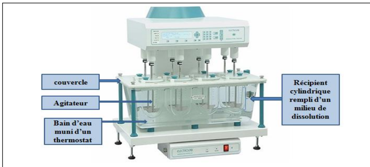
Figure 9: Dissolutest à palette tournante
