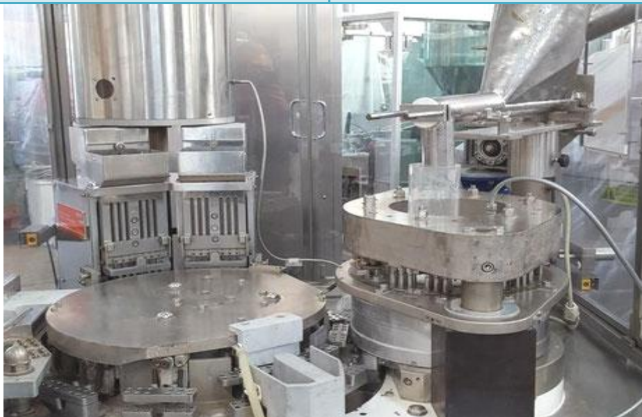
Géluleuse de marque Bosch , modèle : GKF 1200
