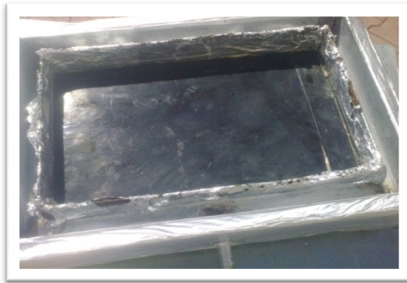
Figure 2.3 : La partie inférieure du distillateur en acier, contenant la plaque absorbante noir et un Isolation thermique.
