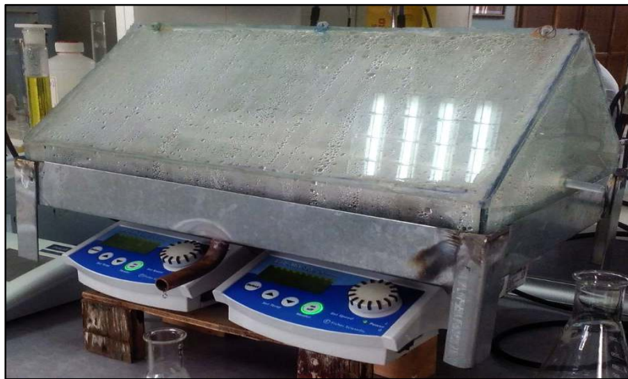
Figure 2.2 : Le montage de distillateur avec énergie électrique
