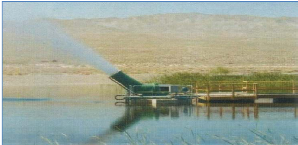
Figure 1.10 : Rejet utilisant l'évaporation par pulvérisation (évaporateur Turbo-Mist) [7].
