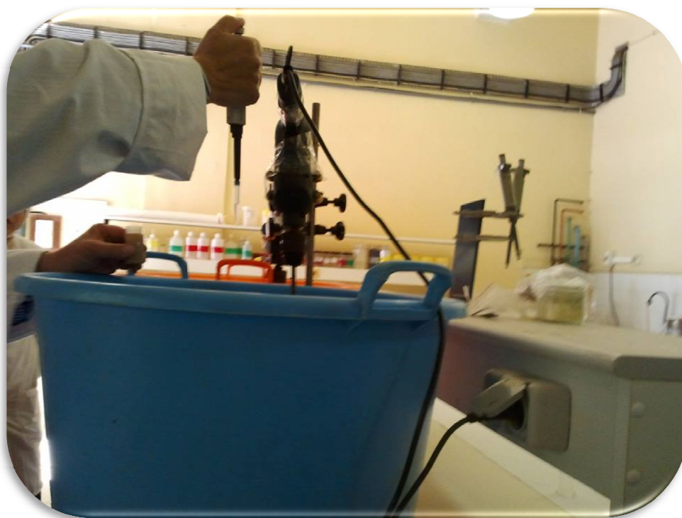
Figure B. 10: L'injection du traceur radioactif.
