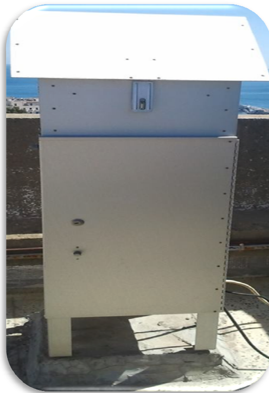
FigureB.13 : Préleveur d'aérosols de marque HVO-3500 AFC.
