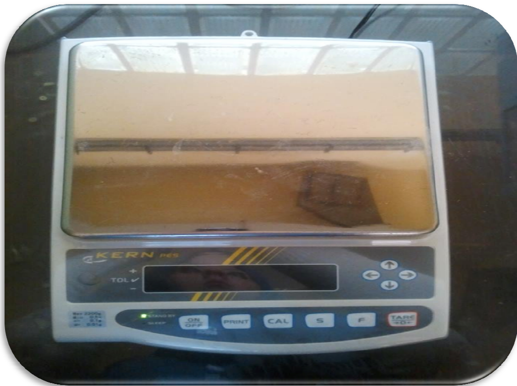
FigureB.4 : La balance de précision de 0.01 de marque KERN
