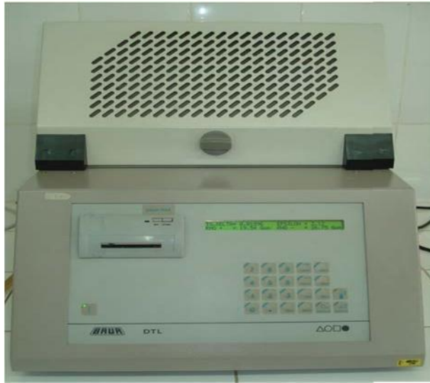
Figure II.10 : BAURDTL pour la mesure du facteur de pertes et de la permittivité relative
