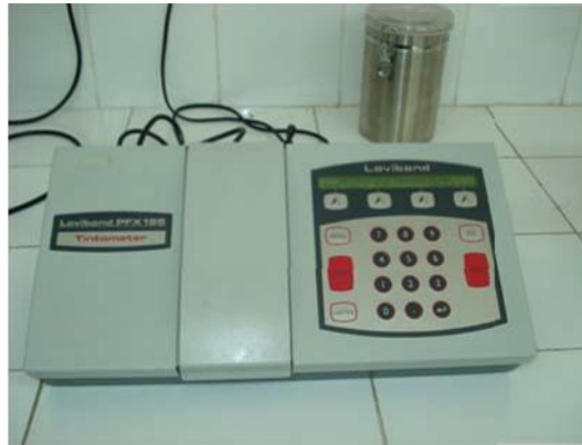
Figure II.8 : Tintomètre Lovibond PFX195 pour la mesure de l'indice de couleur.
