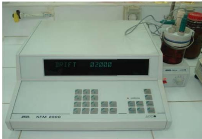
Figure II.7 : BAURKFM2000 pour la mesure de la teneur en eau
