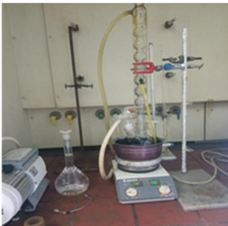
**Figure II.5:**Montage a reflux.
