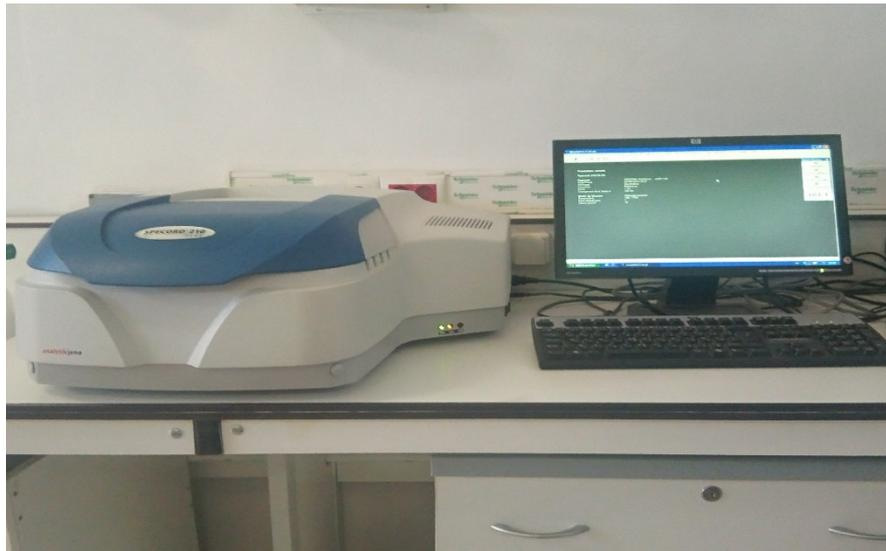
**Figure II-17 :** le spectrophotomètre (SPECORD 200 Plus).
