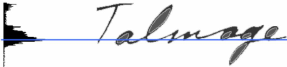
Figure 1.9: Estimation de la ligne de base par la projection horizontale
