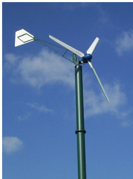
Figure 1.3. Petit aérogénérateur à 3 pales (FORTIS Montana – 5.8kW–24V)
