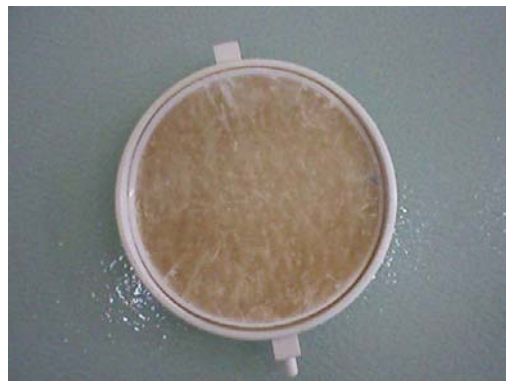
Figure 8.22 Colmatage de la membrane d'UF
