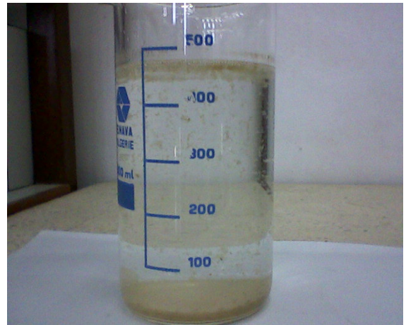
Figures 8.10 - 8.11 Solution avant et après électrocoagulation
