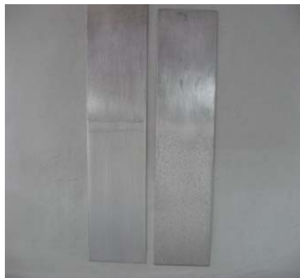
Figure 8.12 Electrodes après électrocoagulation
