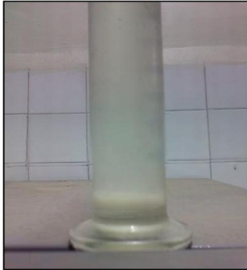
**Figure 3.4 : Précipitation acide de surnageant MM après une nuit de réfrigération à 4°C**
