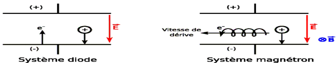
Figure I.14: Vue schématique des systèmes diode et magnétron.
