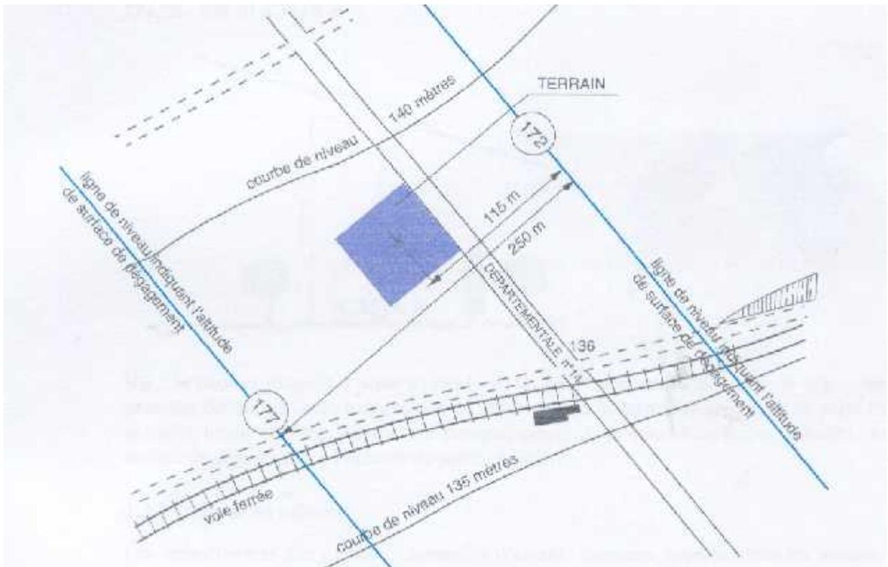
**Fig.3 Evaluation de l'altitude moyenne de le surface de dégagement à l'aplomb du terrain**
