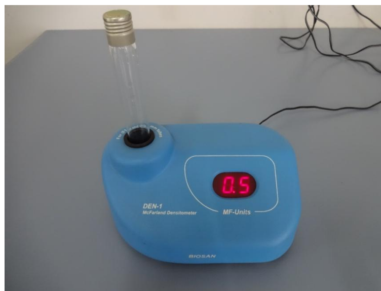
Figure 6.4 : Mesure de D.O. à laide d'un densitomètre [Photo personnelle].
