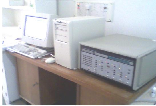
Figure 2-7: potentiostat de marque EG&G modèle 273A
