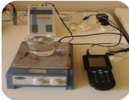
Figure 2-3: pH-mètre et conductivimètre utilisé
