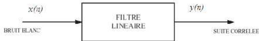
Figure 2.2: Génération d'un signal aléatoire corrélé.
