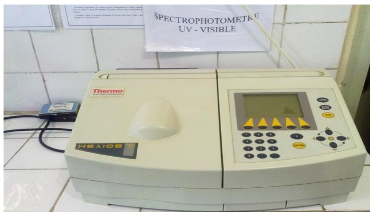
Figure 9 : spectrophotomètre utilisé dans l'analyse de l'absorbance
