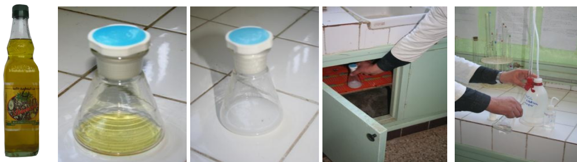
Figure 8 : Etapes d'analyse de l'indice de peroxyde
