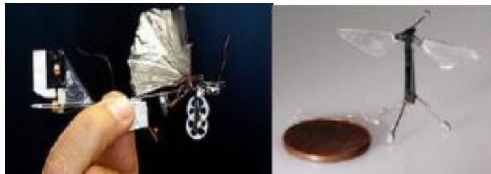
Figure I.13: Exemples des drones à ailes battantes, Le micro Delfly et Le Robobee
