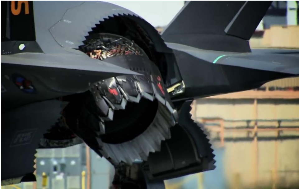
Figure A.6 l'orientation de la tuyères grâce à des vérins hydrauliques.
