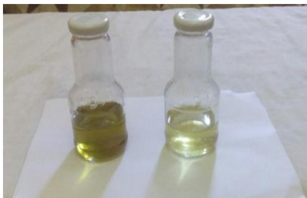
Figure 3.7. Échantillon d'un rejet de DCO avant et après l'adsorption
