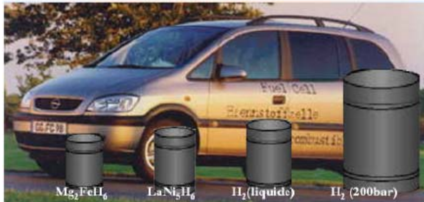
Figure 1.10 : comparaison du volume occupé par 5 kg d'hydrogène suivant le mode de stockage [12]
