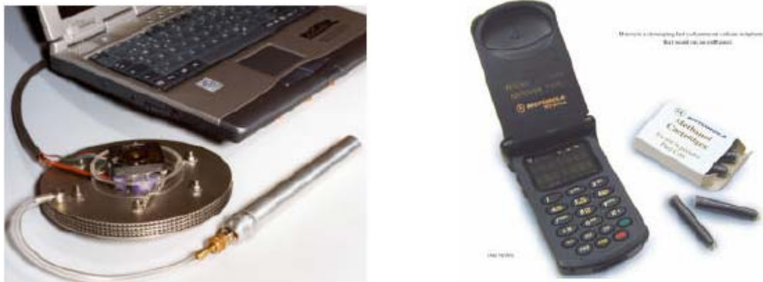
Ordinateur alimenté par une PAC Téléphone portable alimenté par une PAC
