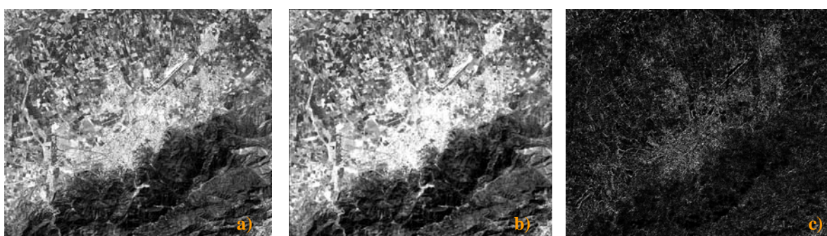
Figure 3.13.2 : Image des résidus (c) à partir de l'ACP1 (a) après opération de fermeture (b) - Blida TM 2001
