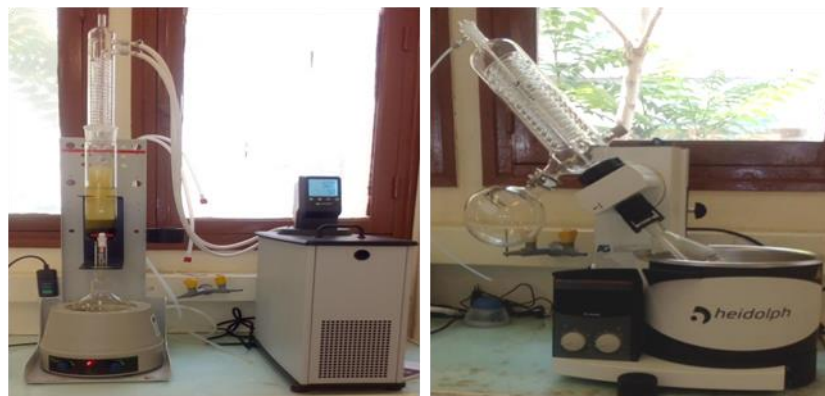
Figure IV.2: Photographie de l'installation d'extraction par Soxhlet (gauche), photographie de l'évaporateur rotatif Heidolph (droite).
